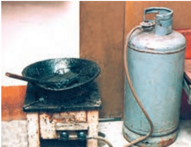
شکل ۳۰-۲- اجاق و ظرف ذوب قیر
